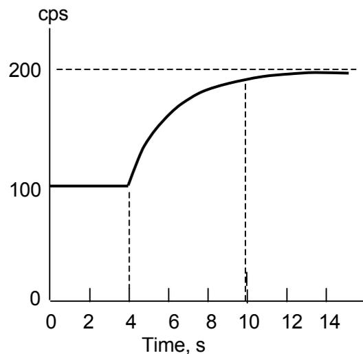
*Fig. 6.24. Rate Meter Response*
