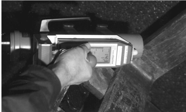
*Fig. 6.34. Wide Range Gamma Survey Meter*
