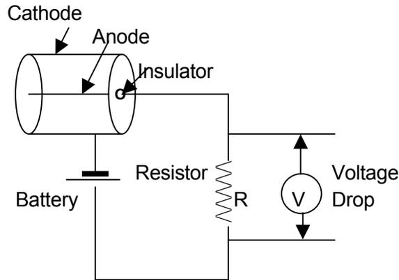
*Fig. 6.4. Ion Chamber Circuit*
