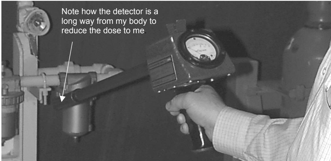
*Fig. 6.5. Emergency Gamma Survey Meter*
