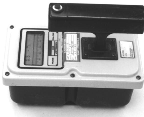
*Fig. 6.16. Low-Range Beta Survey Meter (Top View)*
