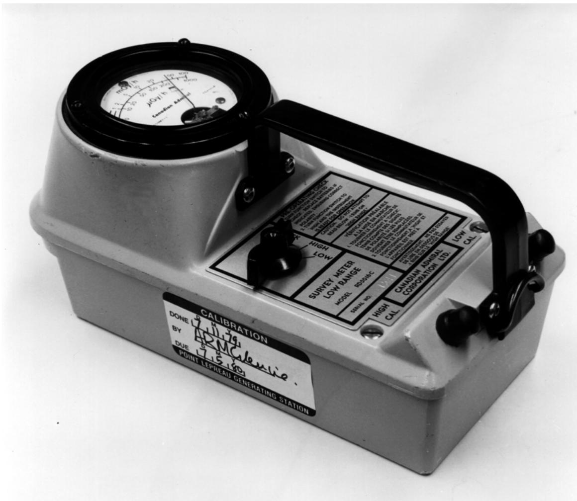
*Fig. 6.14. Low-Range Gamma Survey Meter*
