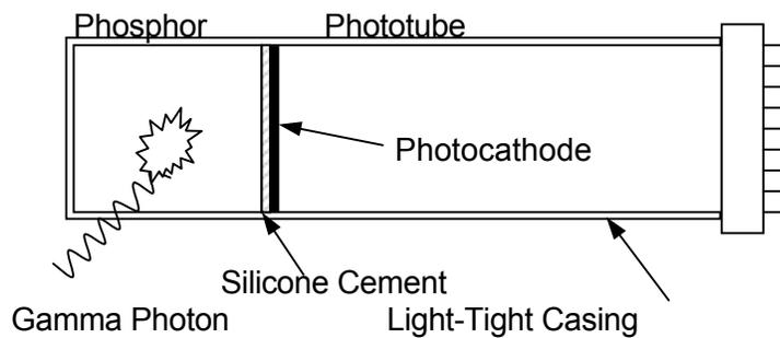
*Fig. 6. 30. The Phosphor-Phototube Assembly*
