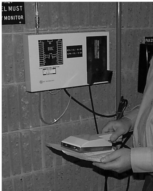
*Fig. 6.10. Alpha/Beta-Gamma Contamination Meter*
